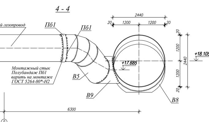
Деталь устройства монтажного стыка
